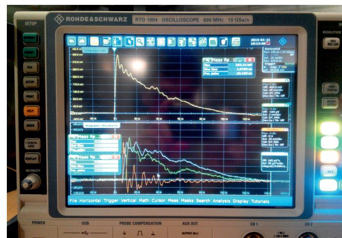
Wewnętrzne stanowisko pomiarowe NEMP składa się z generatora EMP80K-2/23 podłączonego do linii radiacyjnej RL180-50. Natężenie pola generowanego impulsu mierzone jest sondami pola magnetycznego i elektrycznego. Charakterystyki amplitudowe generowanych impulsów rejestrowane są za pomocą dedykowanego oprogramowania.
